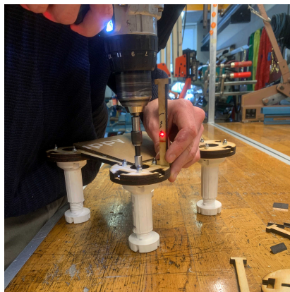
Hoved ikke i korrekt højde og skal indstilles
