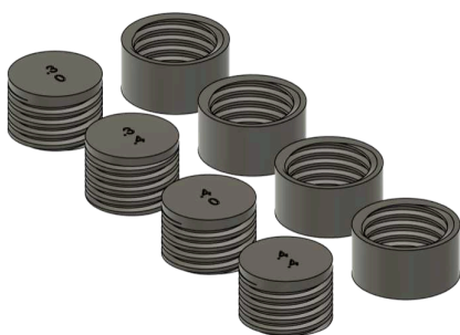
Gevind-stykker med forskellige tolerancer
