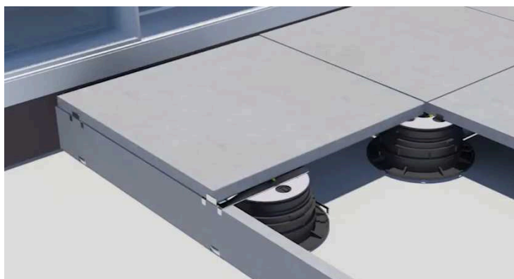
Afslutningsprofil til flisestykker (Murerbutikken. (2020, 6. April))
