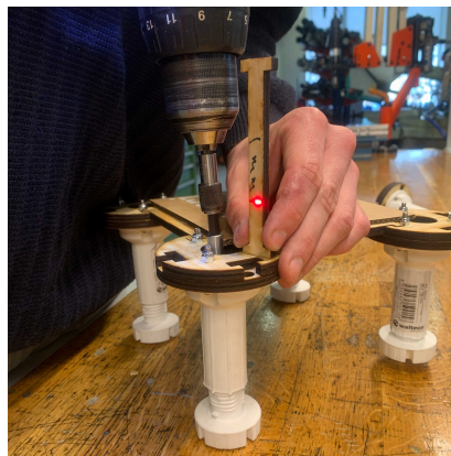
Hoved er i korrekt højde efter indstilling
