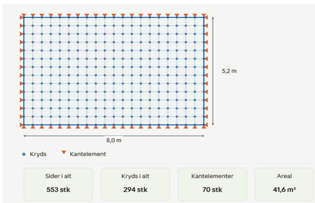
Terrassefod-layout for en 5,2 \times 8\text{ m} terrasse med styk-tal
